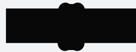
Mối hàn bị gãy ở giữa Nguyên nhân: Không đủ nhiệt hoặc thời gian thao tác hàn chậm
