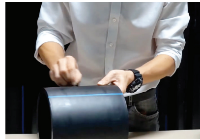
BƯỚC 3: TẠO ĐỘ NHẪM CHO 2 ĐẦU ỐNG (SÂU 0,2MM - 0,4MM)
