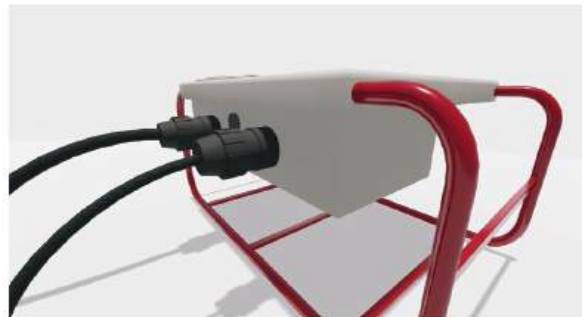
Bước 2: Kết nối nguồn điện cho máy hàn và chọn thông số hàn theo từng loại ống
