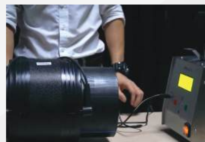
BƯỚC 10: ÁN NÚT ĐỂ BẮT ĐẦU QUÁ TRÌNH HÀN
